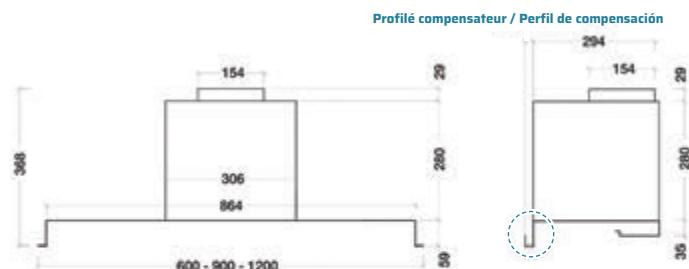
Détail du profilé compensateur dans l'arrière de la hotte pour l'installation du panneau arrière. 4 types de profils différents en fonction de la profondeur du meuble haut.
